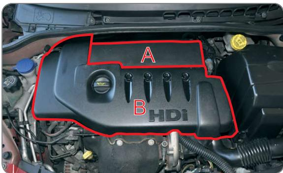
**PL** Zdemontuj pokrywę filtra powietrza (A), zdemontuj maskownicę silnika (B)
