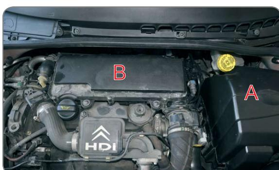
**PL** Zamontuj pokrywę akumulatora (A), zamontuj pokrywę filtra powietrza (B), uruchom silnik, sprawdź szczelność układu paliwa, zamontuj maskownicę silnika
