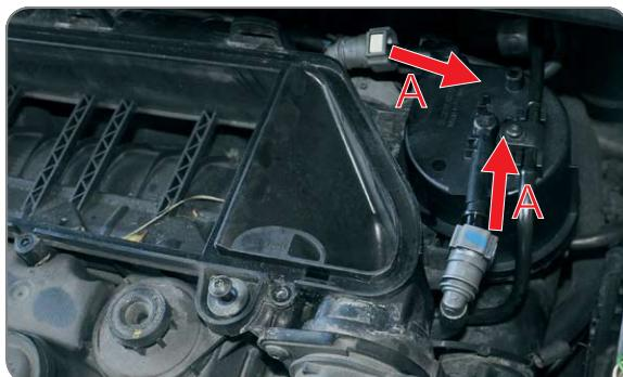
**PL** Podłącz złącze podgrzewacza paliwa, zamontuj nowy filtr w obudowie, następnie zdemontuj zaślepki i podłącz węże paliwa (A)\*\*
